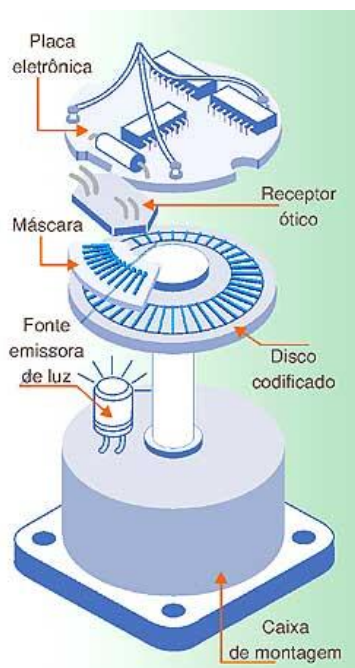
Figura 2 : Funcionamento de um encoder rotativo.
